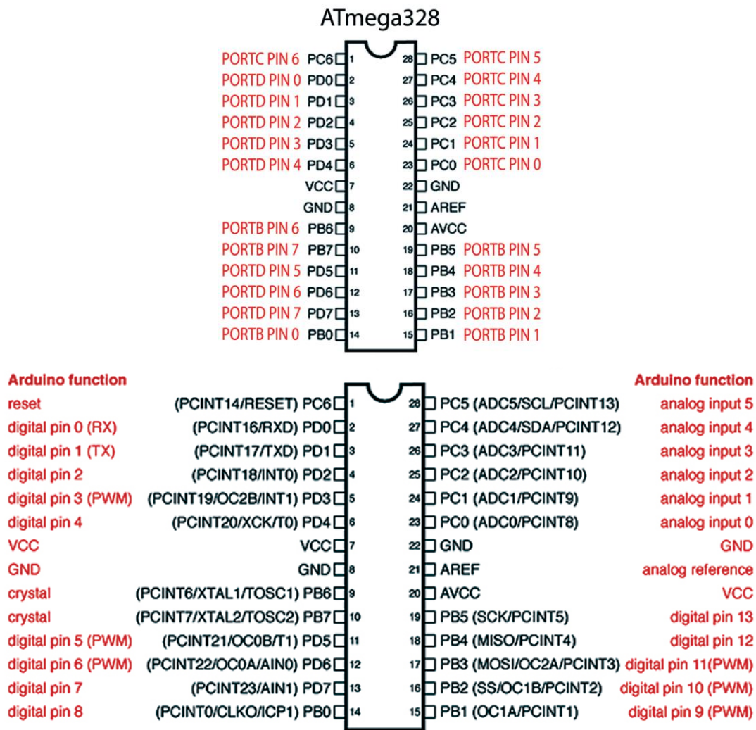
Slika 8.1 Pinovi ATmega328 i Arduino funkcije tih pinova
