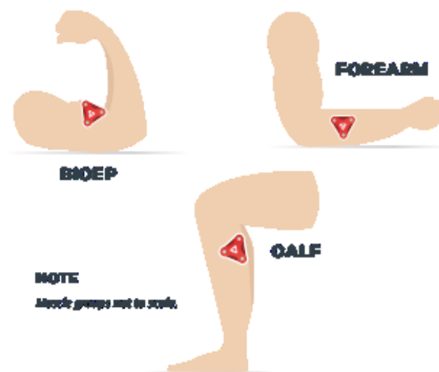
Slika 5. Postavka MyoWare 2.0 mišićni senzora na tri grupe mišića: biceps, podlaktica i list [3]
