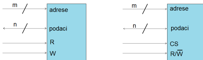
Slika 4.11: Model memorije sa signalima R i W (levo) i signalima CS i R/W (desno)
