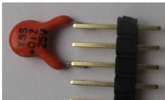
Slika 90. Fizički izgled kondenzatora 10nF
