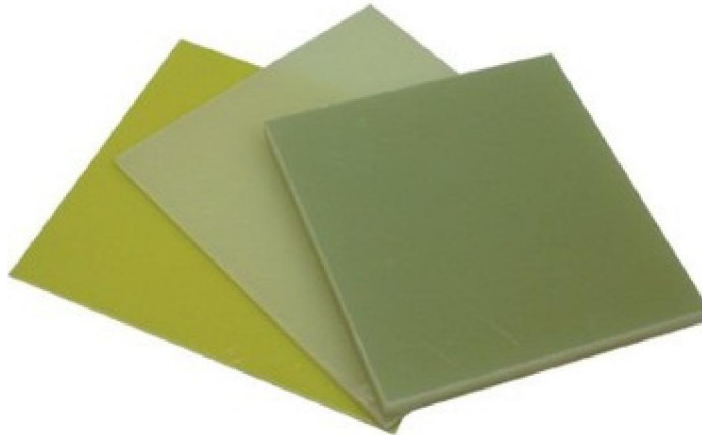
Slika 1. Izgled FR4 materijala za izradu štampane ploče
