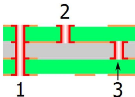
Slika 3. Tipovi vija: "Through-hole"(1), "Slepa"(2), "Ukopana"(3). Nprovodni slojevi su predstavljani zelenom i sivom, a provodni narandžastom i crvenom bojom.
