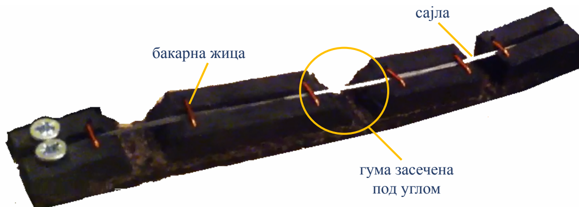
Слика 18. Изглед друге верзије прста у опруженом положају
