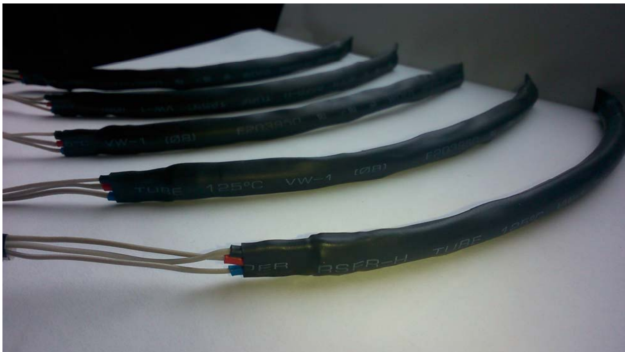
Слика 32. Приказ свих пет сензора након поставке у термо-бужир
