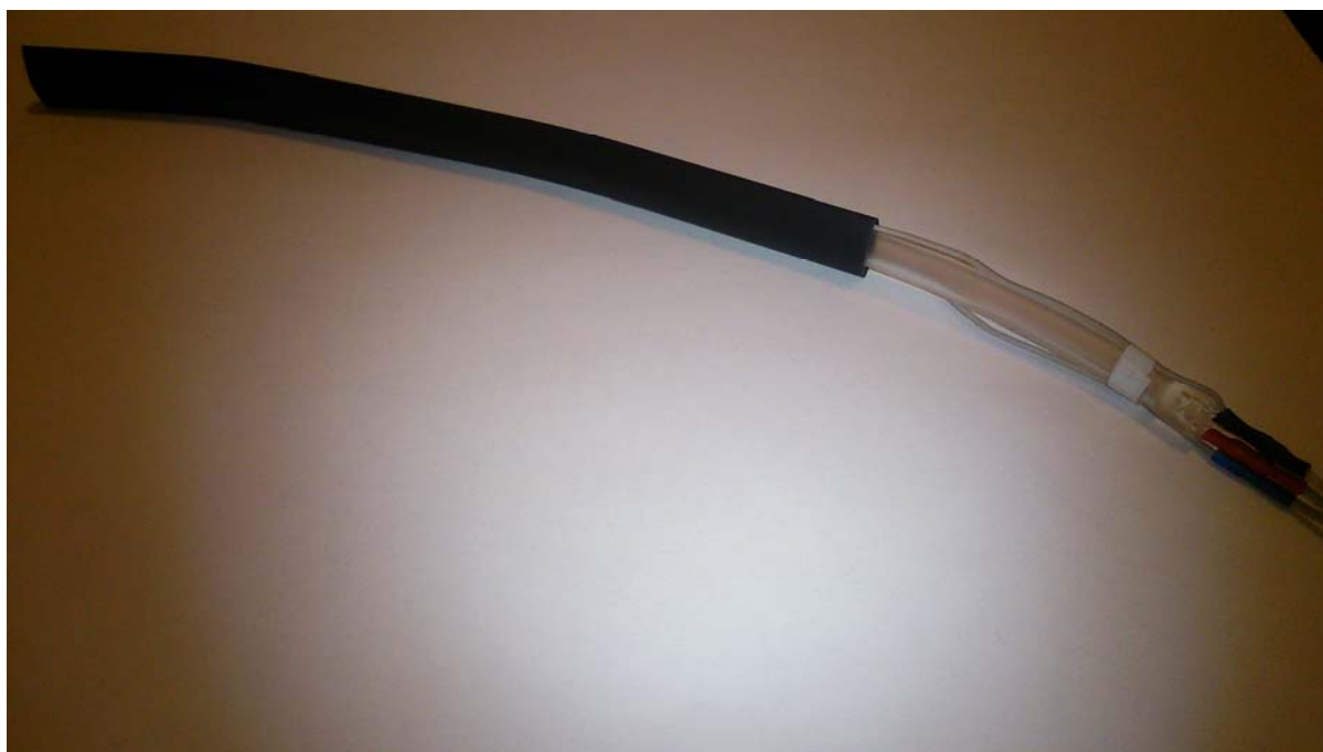
Слика 30. Стављање црева у термо-бужира
