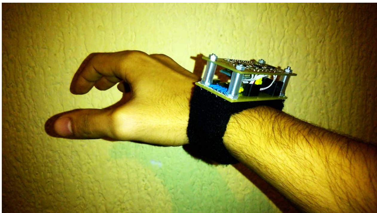
Слика 49. Изглед електронике сензорског дела пришивеног за наруквицу
