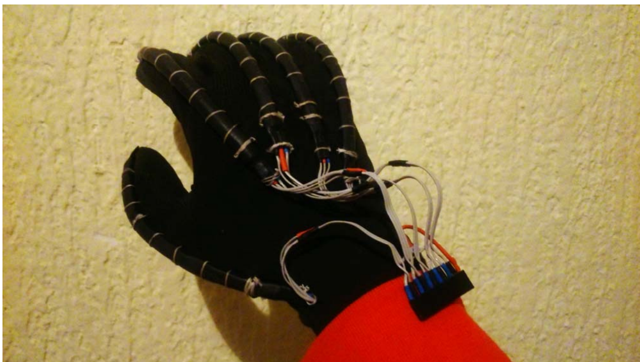
Слика 33. Изглед свих сензора монтираних на рукавицу
