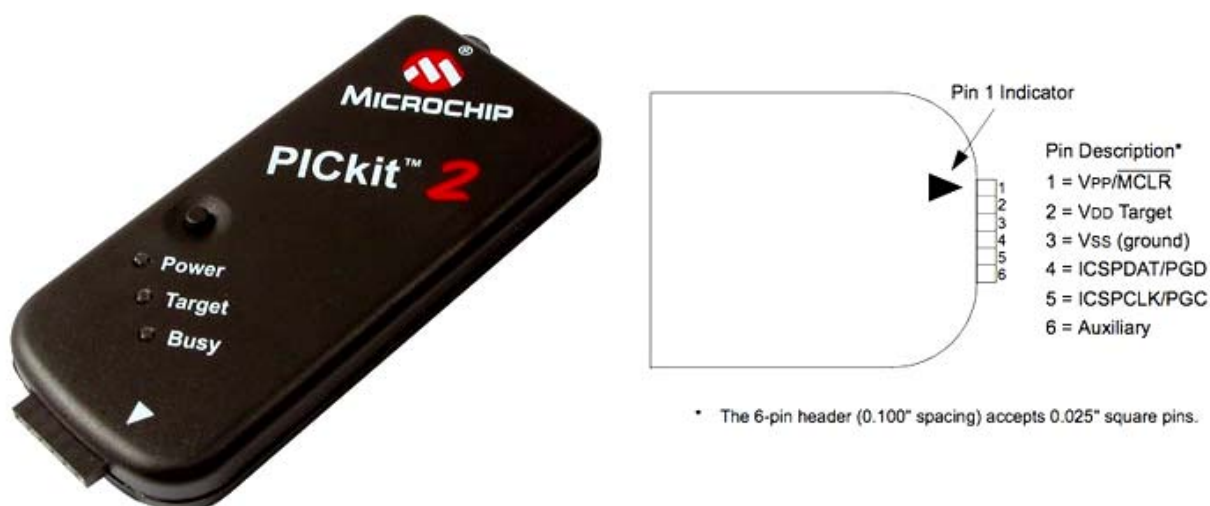
Слика 52. PICkit 2 уз правило за повезивање
