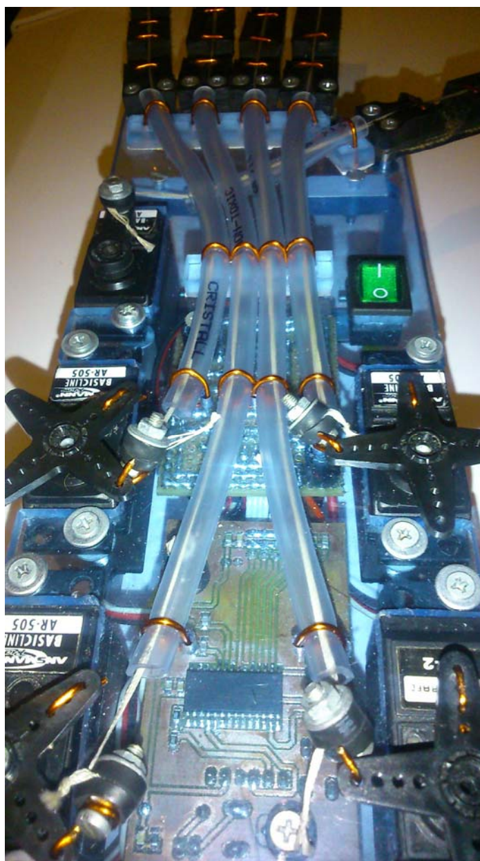
Слика 70. Изглед роботске шаке са цревима која имају улогу вођице за сајле
