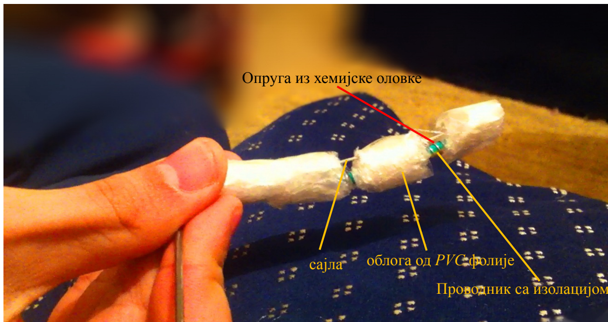
Слика 16. Изглед прве верзије прста у опруженом положају
