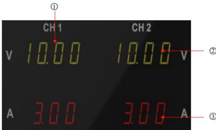
Слика 4: Изглед дисплеја са приказом вредности напона и струје
